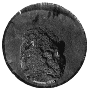
Udmattelsesbrud på en stålaksel
